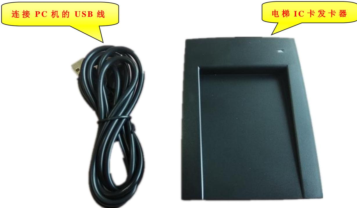
图 3.3 电梯 IC 卡发卡器
